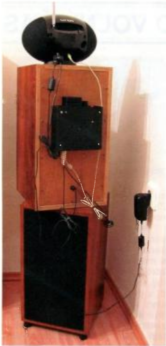
Obr. 9. Celá sestava při pohledu zezadu, na zadní straně horní reprosfrkřinky je vidět namontovaný zesilovač s kabely a přepínací skřínkou, nahoře je přijímač
