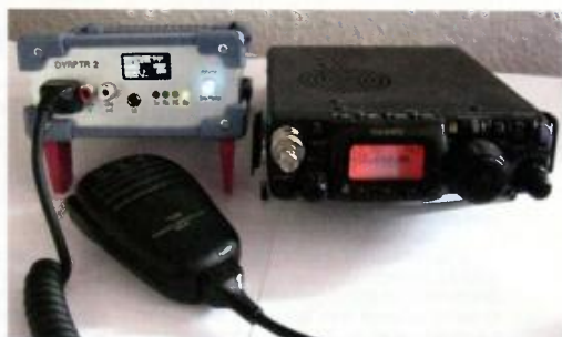
Obr. 1. Babystar je nový produkt od ON8JL, který kombinuje vše potřebné pro vytvoření mini-hotspotu, včetně transceiveru (vlevo)
