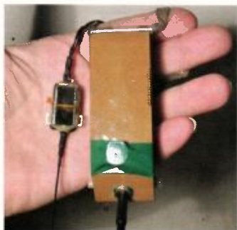
Srovnání velikosti dnešního 5g satelitního vysíláče pro ornitology (vlevo) se 700g vysíláčem používaným před 18 lety
