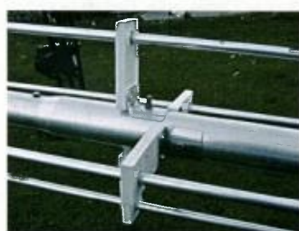
Obr. 4. Zúžení průměru trubky nebývá v podmínkách domácí dílny zpravidla možné, běžně se však vyskytuje u továrně vyráběných antén
