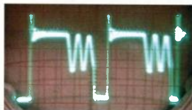
Obr. 4. Oscilogram napětí na svorkách výkonového tranzistoru MOSFET
