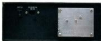
Obr. 62b. Umístění chladiče na zadní straně rozmitače
